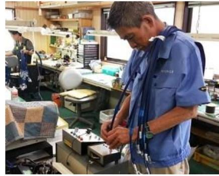
Prueba de conducción de corriente en el cable del brazo del brazo (comprobación del cableado contra el freno del cable o la mala conexión después de la soldadura)
