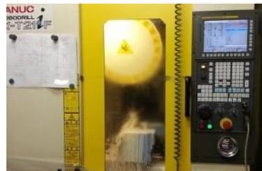
Base de fresado CNC, centro de mecanizado, en funcionamiento
