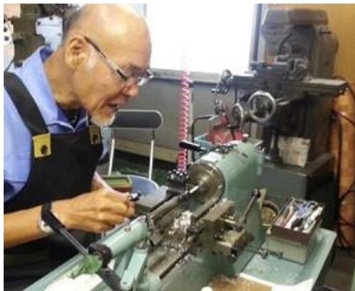
Torno tipo banco para varias piezas mecánicas pequeñas (herramientas de torno de 1 a 15 mm DIA, para material de latón, acero inoxidable, aluminio, plástico Delrin)
