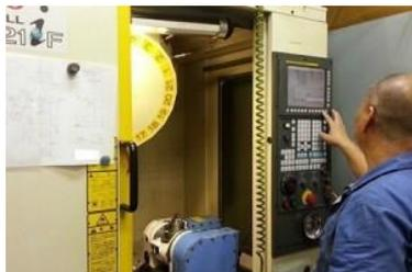
Base de fresado CNC, centro de mecanizado Panel de control
