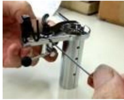
Dispositivo de elevación del brazo de ajuste
