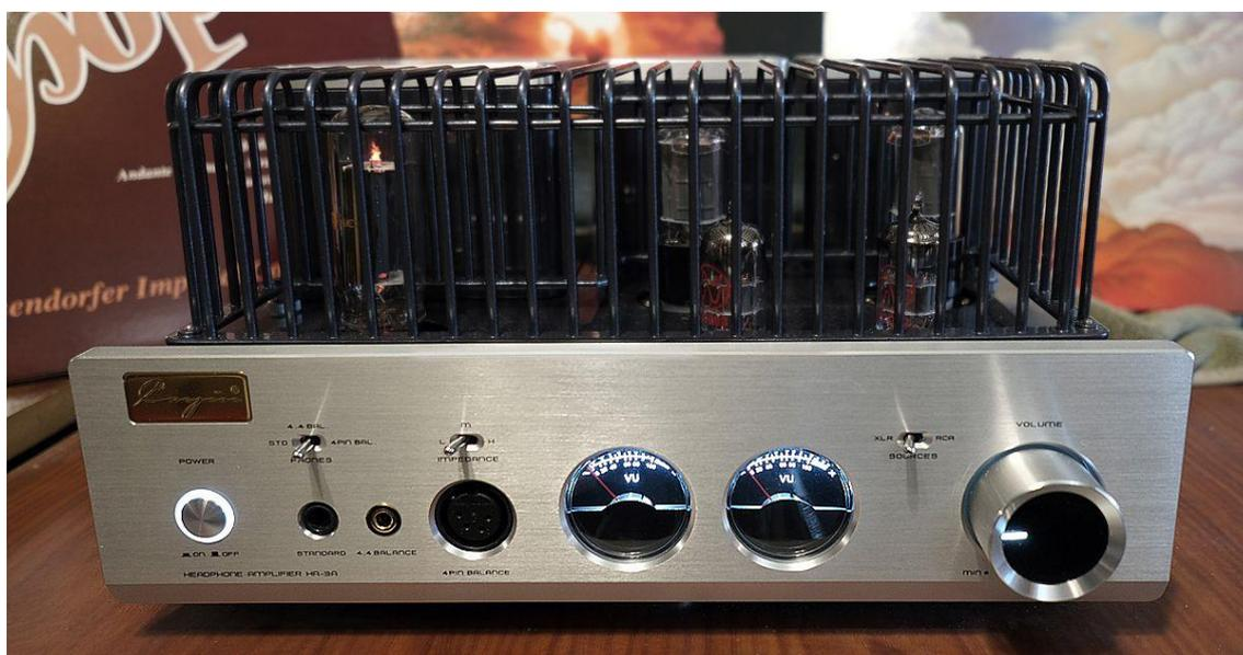
La fuente de alimentación utiliza un tubo rectificador que minimiza la interferencia y proporciona energía limpia al circuito de amplificación. Se utilizan solo válvulas de vacío cuidadosamente seleccionadas y emparejadas a mano en su circuito de terminación única de dos etapas.
