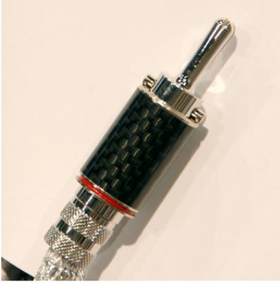
La resistencia del cable es de 7,98 Ohm/Km y su capacitancia máxima es de 68 Pf/m. Los conectores están fabricados en Rodio y fibra de carbono, lo que nos da una señal clara del nivel del cable que estamos tratando. Además las bananas llevan un sistema de anclaje que al girar el cuerpo del conector hacen que esta se expanda, ampliando así la superficie de contacto, asegurando perfectamente la conexión.
