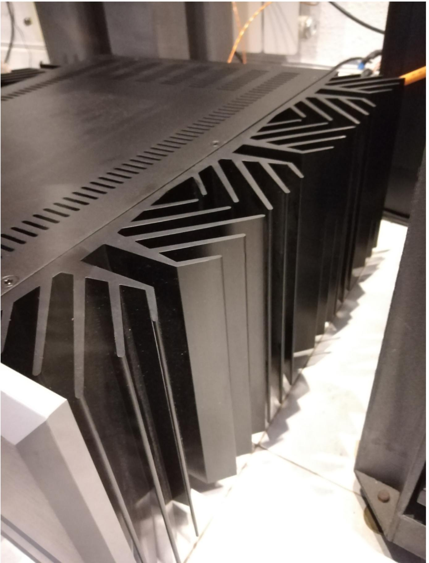
Detalle de los disipadores de calor.
